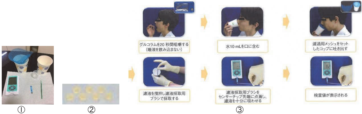
①検査器具一式 ②グルコース含有グミ ③測定方法
